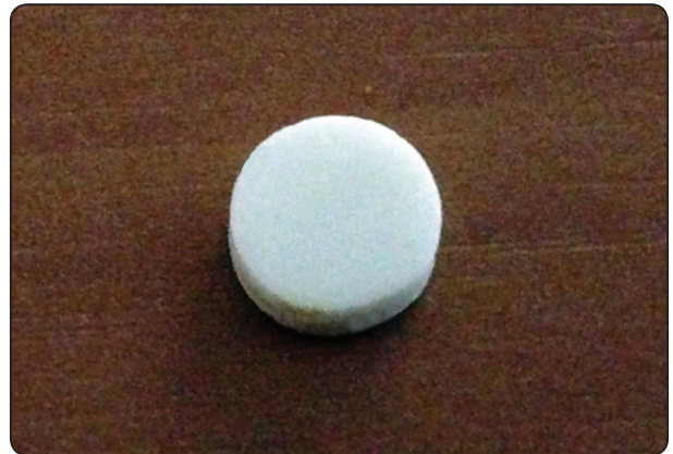
FIG. (1) Sintered zirconia disc.
